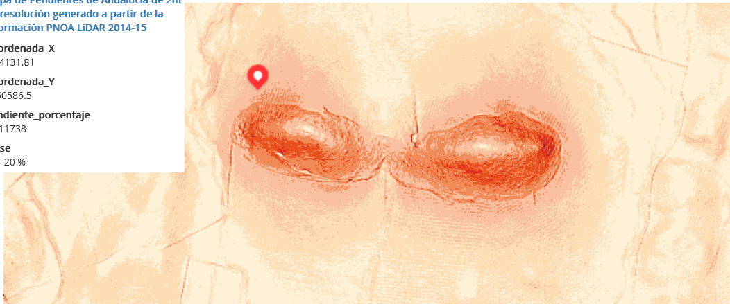
Figura 5: Mapa de pendientes de la zona, con indicación del punto donde se localiza la planta dosificadora de hormigón. Fuente: REDIAM
