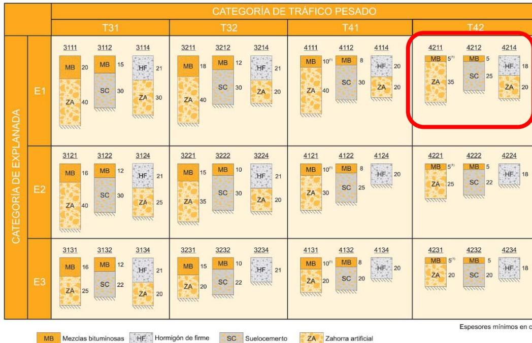
(1) Estas capas bituminosas podrán ser proyectadas con mezclas bituminosas en caliente muy flexibles, grauemulsión sellada con un tratamiento superficial o mezcla bituminosa abierta en frío sellada con un tratamiento superficial.
