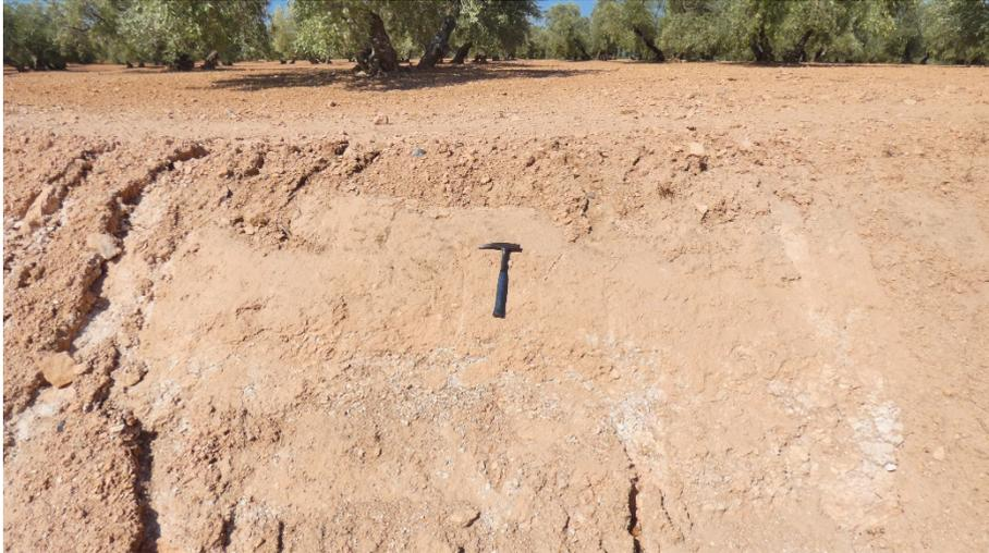
Foto 13. Afloramiento de cantos calizos y arcillas rojas en el borde sur de la parcela, correspondientes a depósitos de terrazas aluviales
