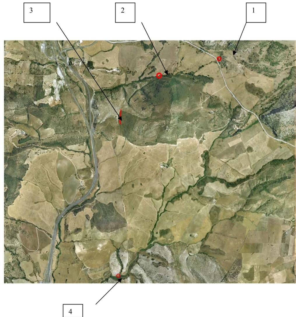
Los diversos elementos registrados del acueducto Fuente del Higuérón- Casabermeja en el T.M. de Antequera, sobre ortofoto 1:5.000 (en formato original): 1. Captación de agua en la Fuente del Higuérón. 2.Arquería sobre el arroyo La Fresneda (tramo 1º). 3.Posible tramo en galería subterránea. 4. Arquería (destruida) sobre el arroyo Valdivia.
