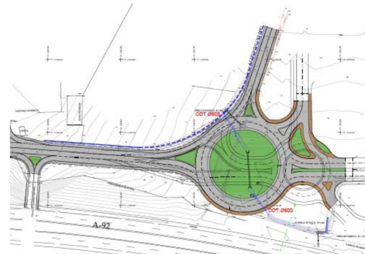
Con respecto al tramo existente del acceso al CLA que se pretende remodelar, se procederá a anular uno de los pasacunetas existentes, disponiendo un nuevo trazado del mismo que permita la conexión con el existente bajo tramo de calzada actual que quedará embebido dentro del interior de la glorieta y que conectará finalmente con la obra de fábrica existente.
