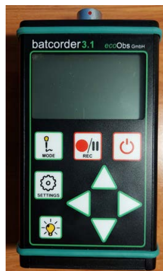
Registrador grabador de ultrasonidos con el que identificar las especies de quirópteros presentes en la zona.
